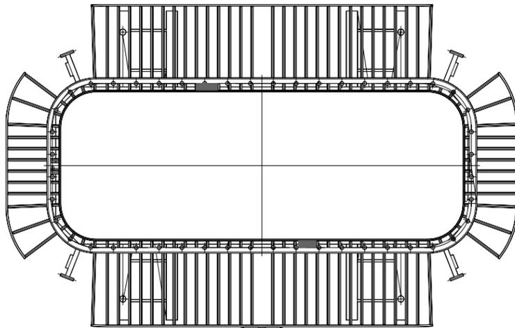
Рис. 2. Расположение сварных швов на силовом трансформаторе мощностью 1000 кВА
