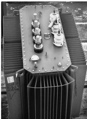
ема масла компенсируется за счет пластичной деформации гофрстенок баков, а не за счет маслорасширителя, как на трансформаторах серии ТМ. Благодаря проведенной исследовательской работе на Минском заводе была сохранена овальная форма бака с использованием гофрированных стенок (Рис. 1).
