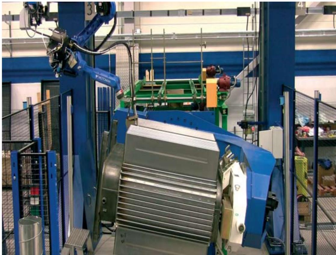
Комплекс оборудования для автоматической дуговой сварки гофрированных баков силовых трансформаторов, оснащенный сварочным роботом фирмы Motoman, Швеция
