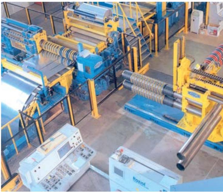
Автоматизированная линия продольного раскроя электротехнической стали фирмы Georg, Германия
