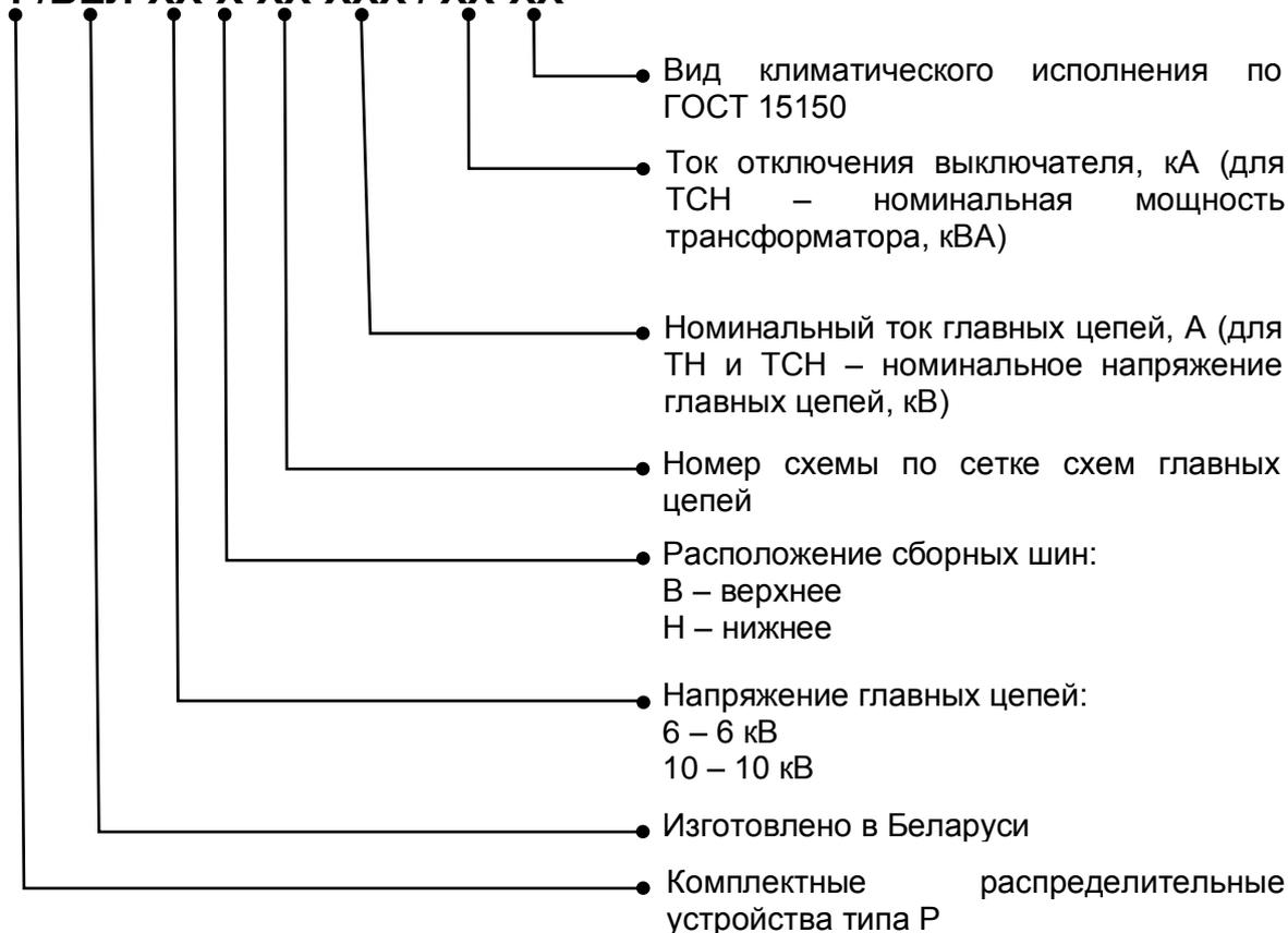
Пример условного обозначения шкафа КРУ серии Р/БЕЛ в металлической оболочке внутренней установки с верхним расположением сборных шин, по сетке схем главных цепей 101, на номинальный ток 630 А, ток отключения выключателя 20 кА, вид климатического исполнения УЗ:
