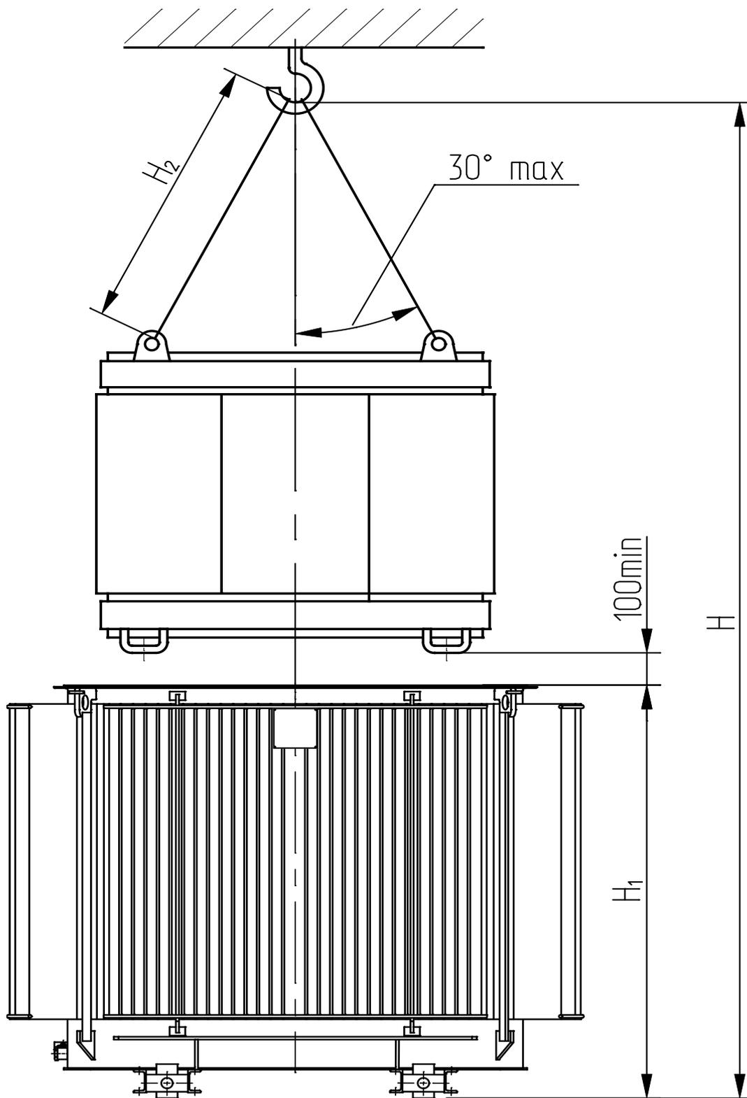
Рисунок А.21 – Эскиз подъема активной части трансформаторов мощностью 1000–1250 кВ·А
