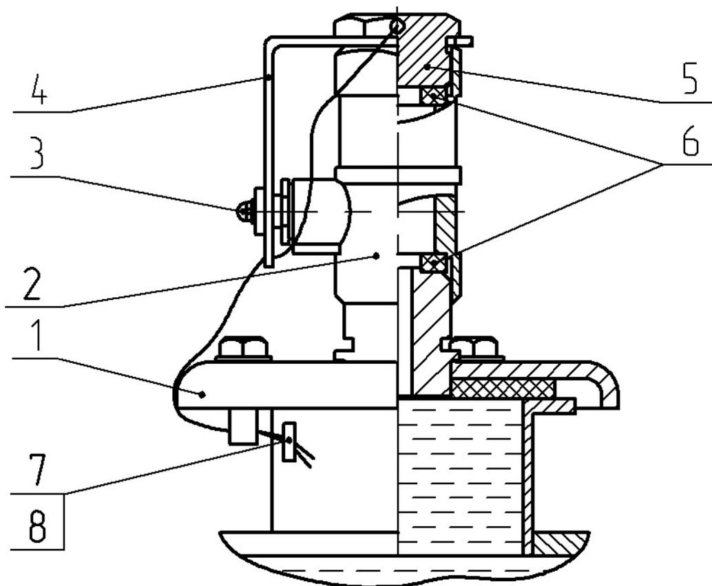
1 - крышка патрубка; 2 - кран шаровой; 3- винт; 4 - ручка крана;
