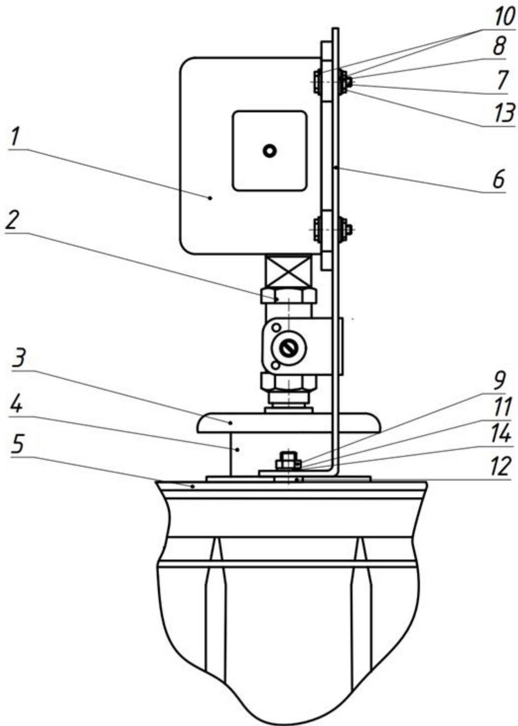
1 - мановакуумметр; 2 - кран шаровой; 3 - патрубок; 4 - крышка бака;
