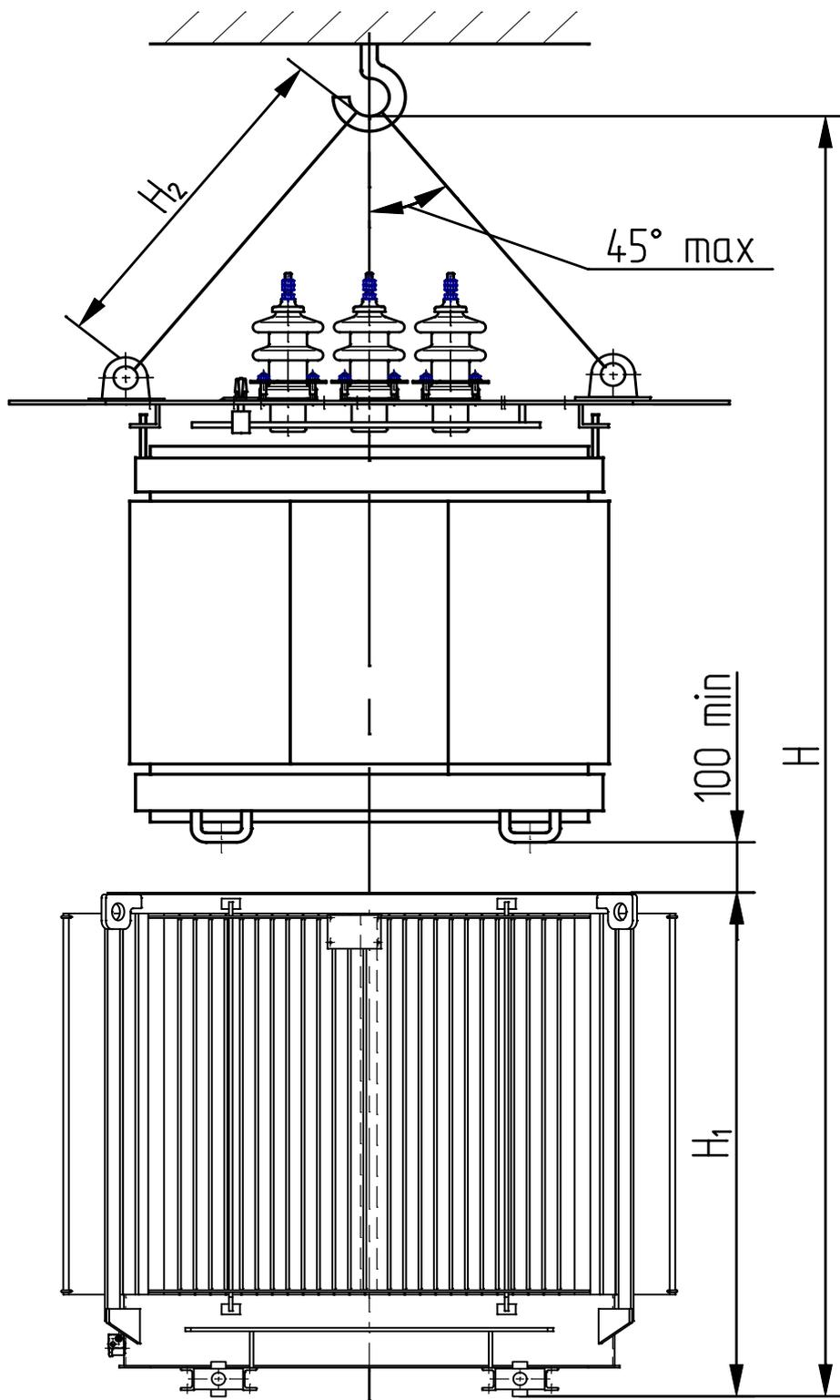
Рисунок А.20 – Эскиз подъема активной части с крышкой трансформаторов мощностью 250–630 кВ·А
