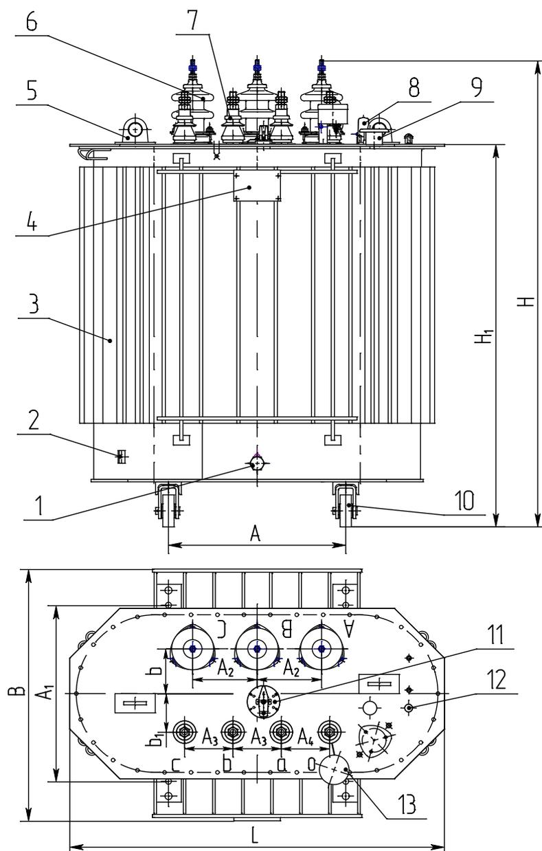
1 - пробка сливная; 2 - зажим заземления; 3 - бак; 4 - табличка; 5 - серьга для подъема трансформатора; 6 - ввод ВН; 7 - ввод НН; 8 - маслоуказатель; 9 - патрубок для заливки масла; 10 - ролик транспортный; 11 - переключатель; 12 - гильза для термометра; 13 - пробивной предохранитель (устанавливается по заказу потребителя)
