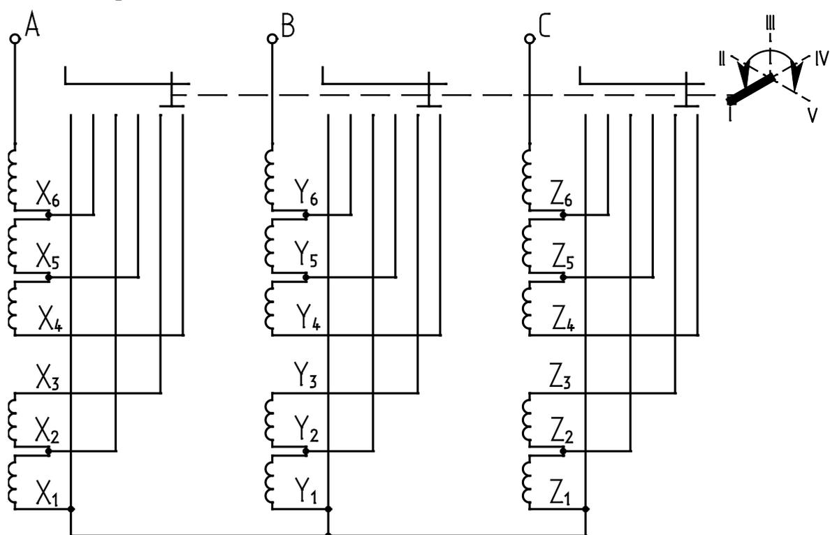
Рисунок А.13 – Схема подсоединения ответвлений обмоток ВН к переключателю в трансформаторах мощностью 630–1250 кВ·А при схеме соединения обмоток – «ЗВЕЗДА»
