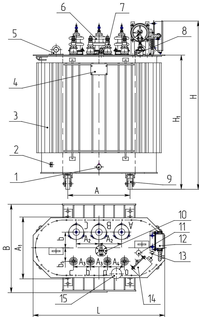
1 - пробка сливная; 2 - зажим заземления; 3 - бак; 4 - табличка; 5 - серьга для подъема трансформатора; 6 - ввод ВН; 7 - ввод НН; 8 - патрубок для заливки масла; 9 - ролик транспортный; 10 - переключатель; 11 - маслоуказатель; 12 - коробка зажимов (устанавливается при заказе мановакуумметра); 13 - гильза для термометра; 14 - мановакуумметр (устанавливается по заказу потребителя); 15 - пробивной предохранитель (устанавливается по заказу потребителя).
