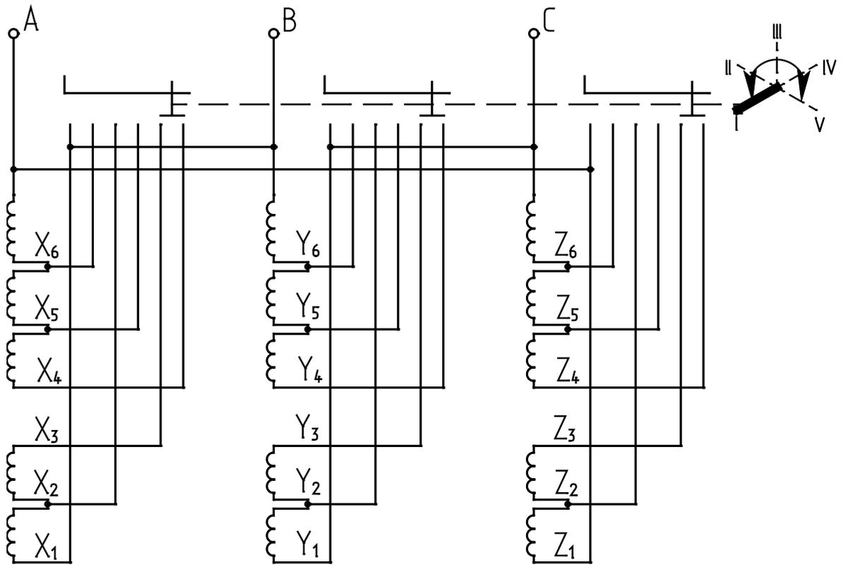
Рисунок А.14 – Схема подключения ответвлений обмоток ВН к переключателю в трансформаторах при схеме соединения обмоток – «ТРЕУГОЛЬНИК»
