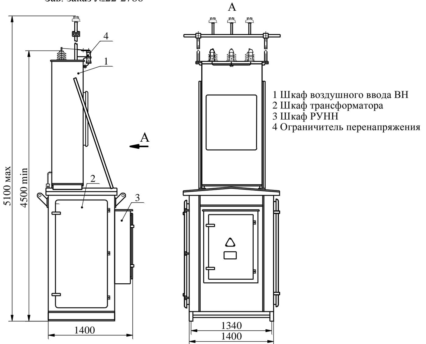
1 Разъединитель РЛНД на время транспортирования помещается в шкаф трансформатора
